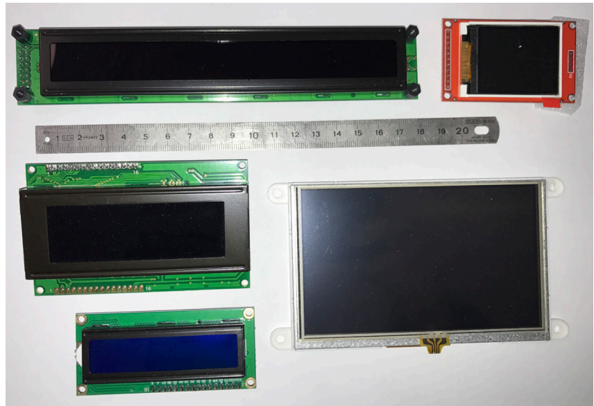
Photo 7 : exemples d'écrans pour Arduino (TFT couleur en bas à droite, OLED couleur en haut à droite, les autres sont des LCD classiques à lignes de caractères).
