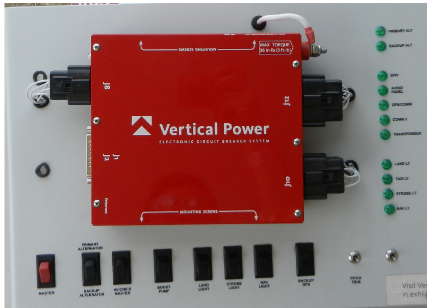
Photo 1 : Le boîtier VP-X Pro monté sur un panneau de démonstration.
