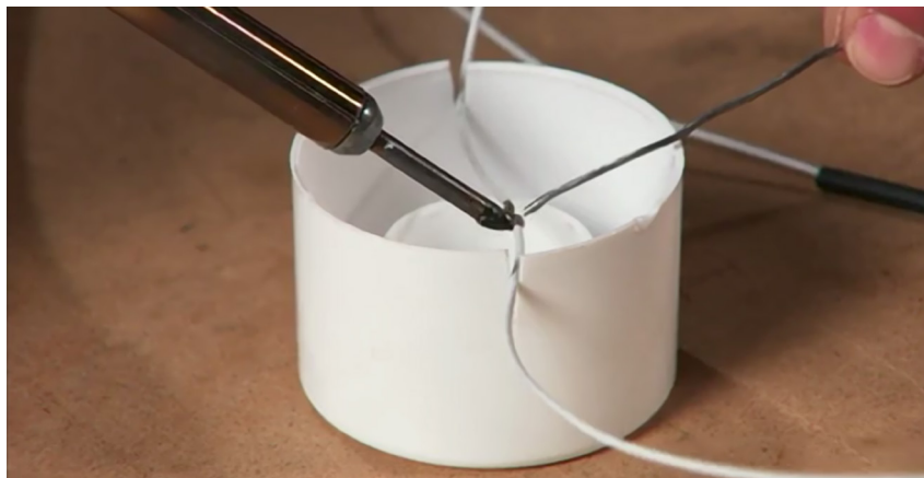
Photo 6 : Support pour souder des fils avec seulement deux mains.
