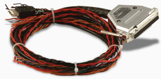
Photo 9 : Câble type du SV network
